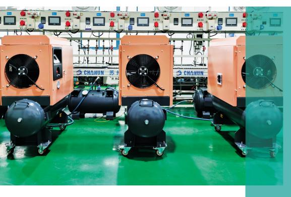
针对15bar压力工况特殊订制的双螺杆空压机,轴承,轴封经特殊改进设计13-15bar 工作压力以下可长期运行,整机集成于一体,结构紧凑,节省空间。
